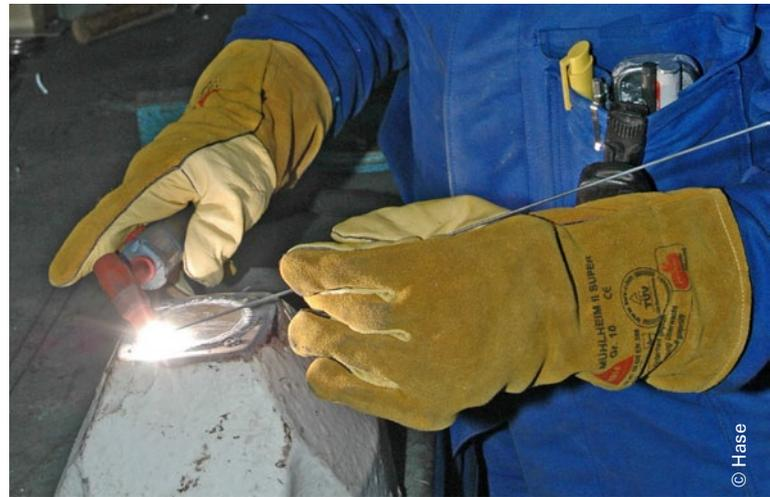
Allgemein gehört das Lichtbogenschweißen zu den Schmelzschweißverfahren bei örtlich begrenztem Schmelzfluss mit oder ohne gleichartigem Schweißzusatz. Im Gegensatz zum Löten wird dabei die Liquidustemperatur (Schmelztemperatur) der Grundwerkstoffe überschritten.
